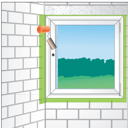
Obr. 6: Fólii důkladně přitlačte válečkem
